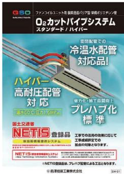
● 冷温水配管用。酸素透過バリア型架橋ポリエチレン管システム。国土交通省NETIS登録品。
